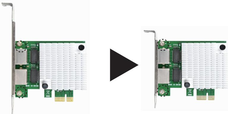
2箇所のネジを取り外して頂き、ロープロファイルブラケットへ交換後取り外したネジで固定をしてください。
