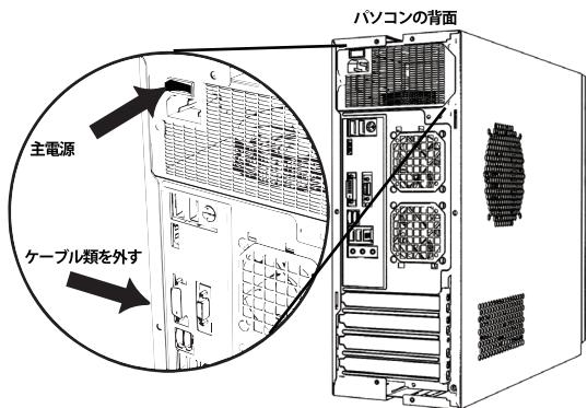
PCは精密機械ですので、増設する前に、身の回りの金属物に手を触れて静電気を逃がしてください。プラストライバをご用意し、平らかつ安定している場所で作業をしてください。
